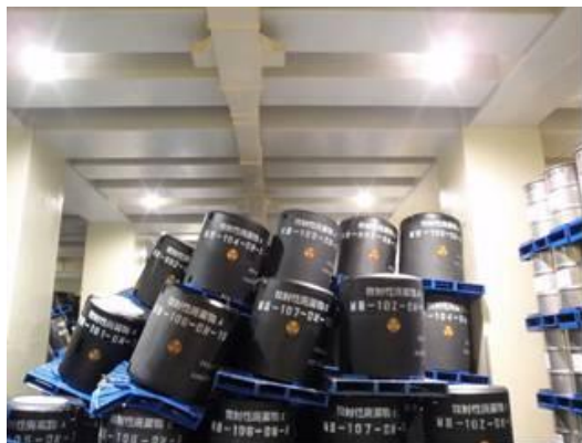
保管体荷崩れの状況
