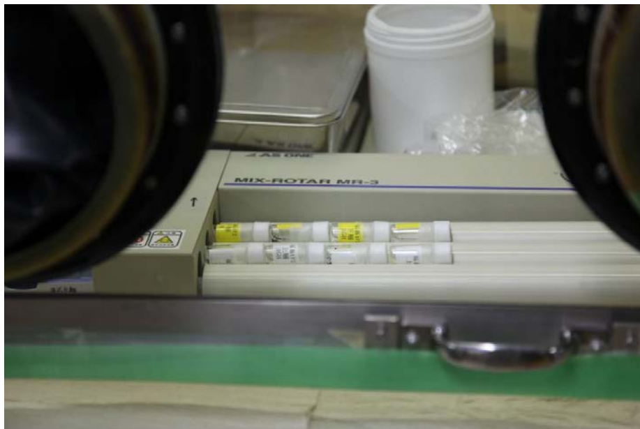
図2-50 Cs吸着試験（吸着剤：ゼオライト）
